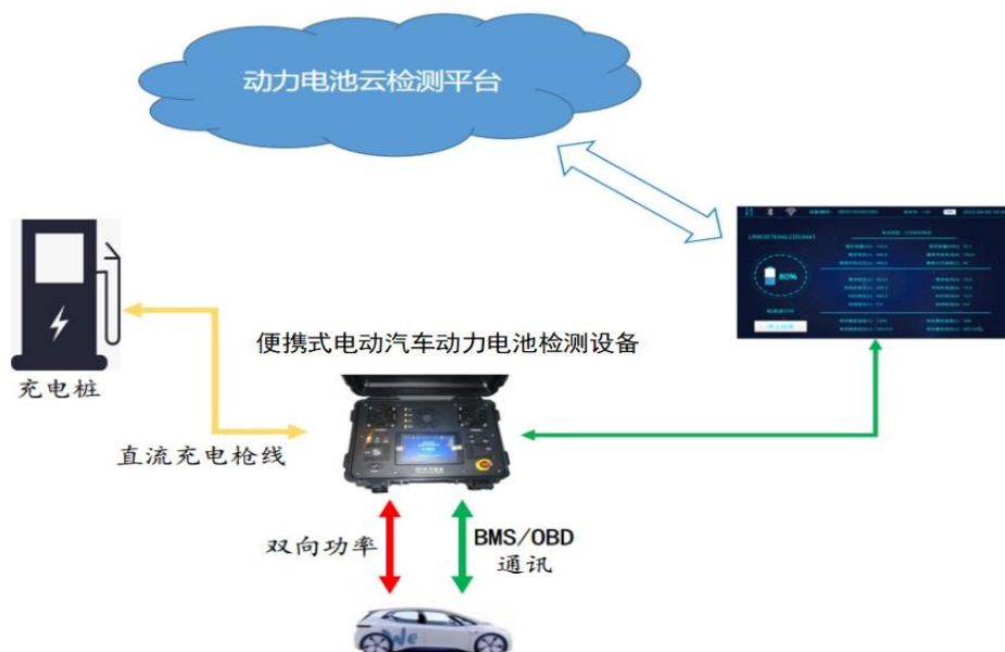
图 2 电动汽车动力电池充电智能检测过程示意图
